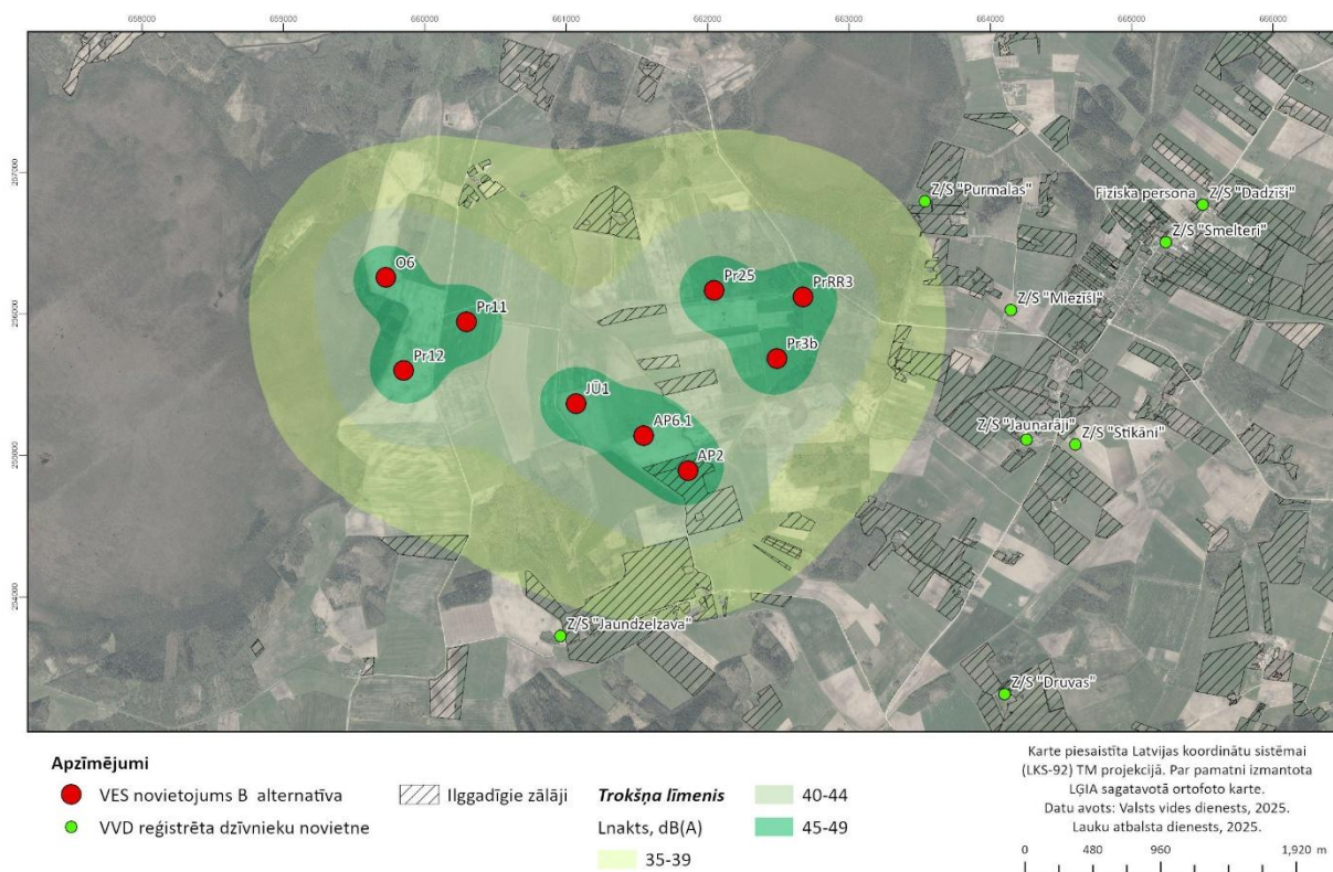
3.12.12. attēls. VES radītais trokšņa līmenis nakts laikā - B alternatīva, ziemeļu daļa
