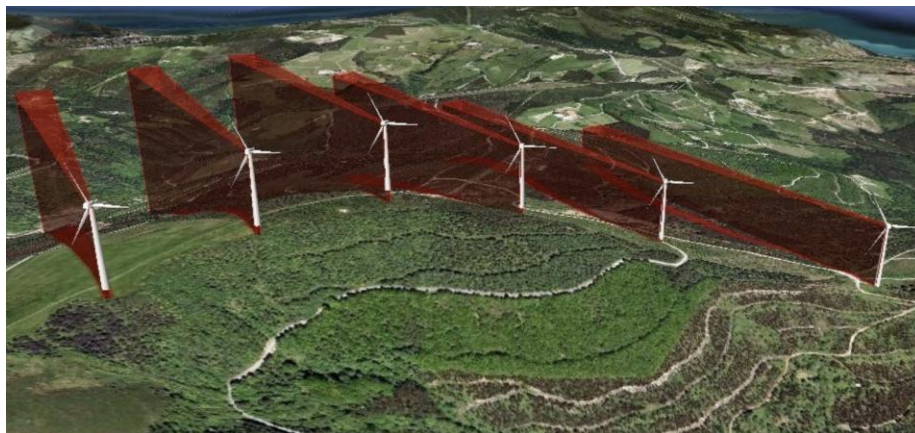
3.11.1. attēls. Aprēķinu piemērs par VES radītu zonu, kurā tiek bloķēts radara stars 303
